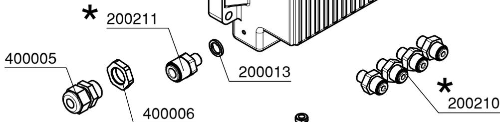
\* FISSARE CON ANAEROBICO
